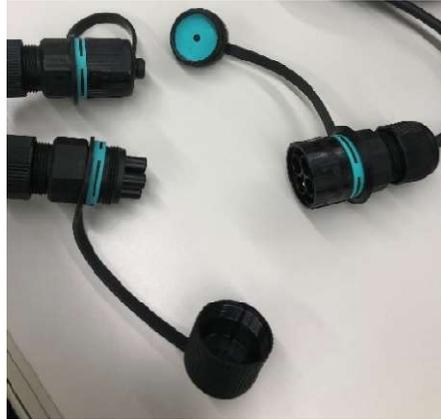
②コンバーターのプラグをセンサーのソケットに挿す
